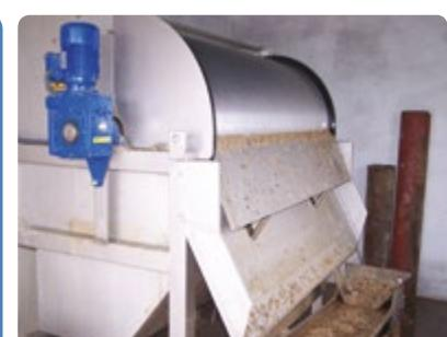
Шнековые решетки **SYG SYSTEM** – это комбинированные системы, состоящие из механической решетки, безвального винтового транспортера и пресса.
