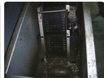
Барабанное сито **TORO** применяется на стадии механической очистки сточных вод и предназначено для непрерывного удаления твердых загрязнений. С помощью барабанного сита можно удалить до 30% твердых частиц и взвесей.
